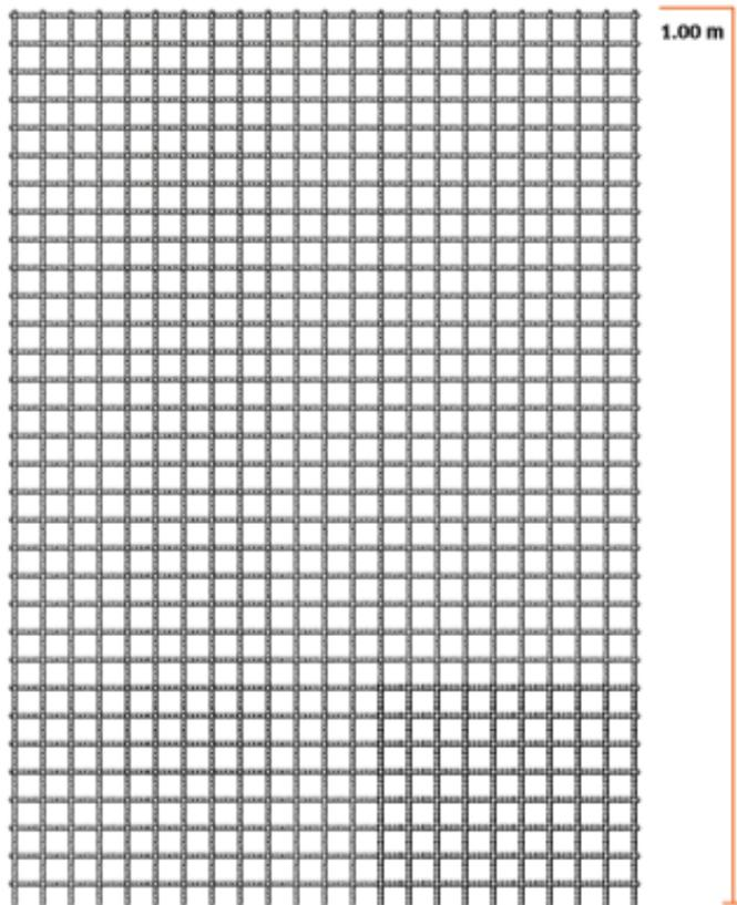
Malla cuadrada formada con alambres galvanizados ondulados y soldados de manera uniforme en los puntos de cruce.
