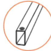
Poste Calibre 14 2 1/2" x 1 1/2" Galvanizado interior y exterior
